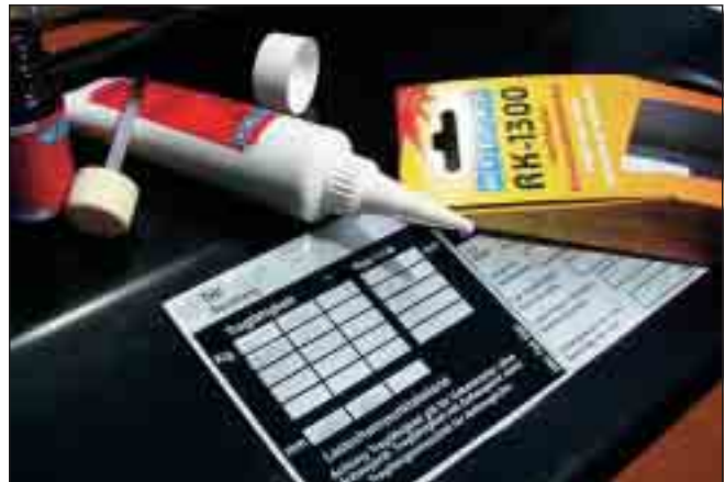
Verlijming van type-aanduidingplaatje - metaal op metaal
